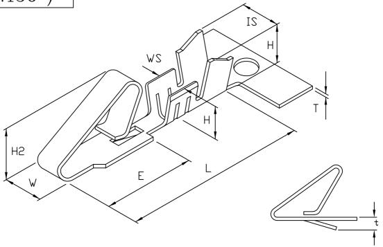
産品編號 Part No: MCN-3101-0003 名 Product: 端子 TERMINAL 品 質 Material: Brass/Phos 材 材料厚度Thickness: 0.25mm
