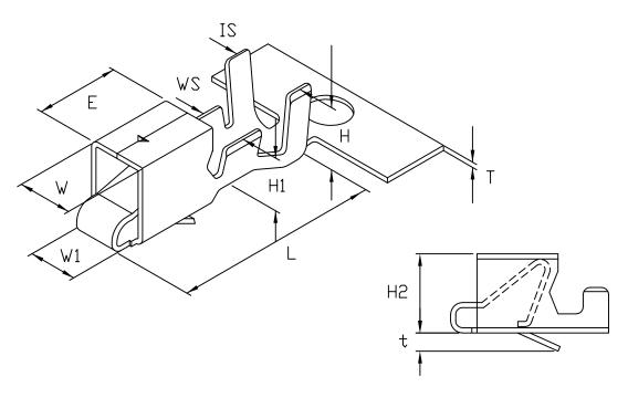
産品編號 Part No: MCN-3101-0004 名 Product: 端子 TERMINAL 品 質 Material: Brass/Phos 材料厚度Thickness: 0.25mm 包裝數量 Standard Packing: 4000PCS 適用電線 Suitable Wire: 18~22AWG
